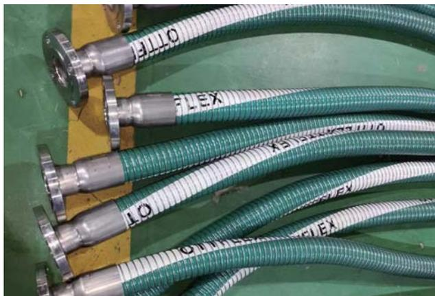
专门输送低温液态介质具有很好的柔韧性和保温隔热功能；适用于公、铁路罐车、库区、码头船舶的低温介质传输装卸。
