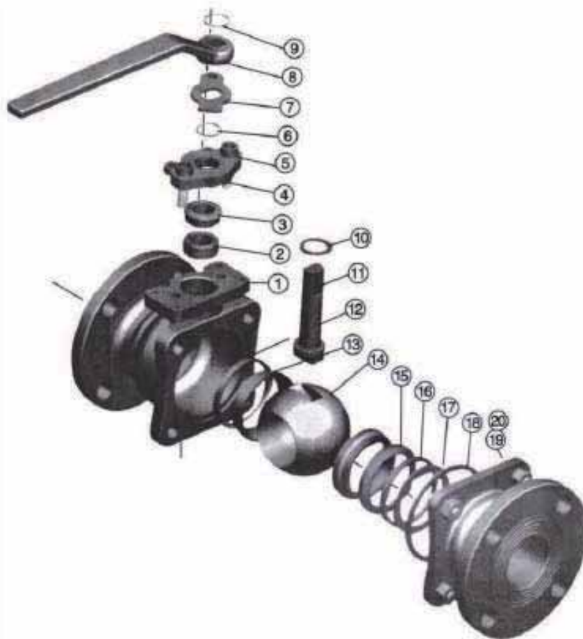
金属硬密封浮动球阀典型结构及零部件组成
